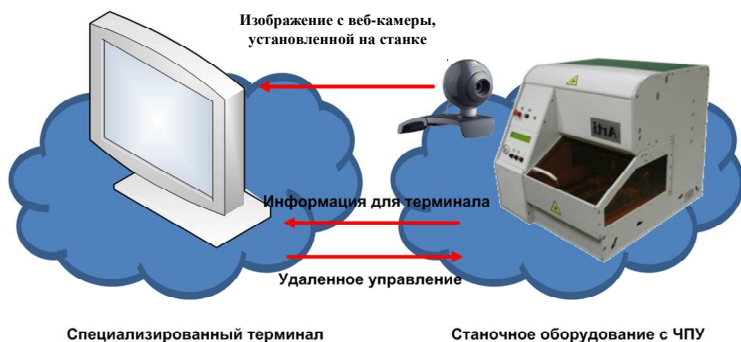
Рис. 3. Концепция обучения с поставкой методических материалов и терминального программного обеспечения для подключения к удаленному оборудованию и принятия сигнала с веб-камеры
