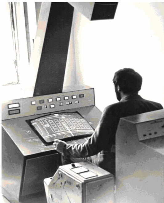
Рис. 1. Первое поколение тренажера портальных кранов
