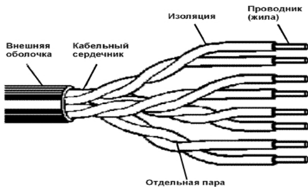
Рис. 1. Основные элементы конструкции LAN-кабеля
