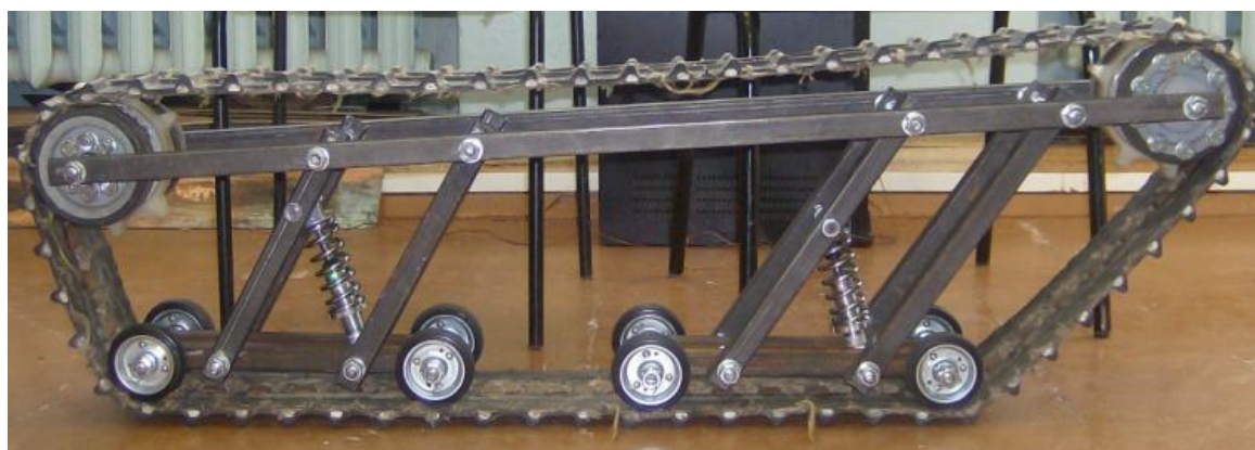
Рис. 4. Гусеница для мобильной платформы
