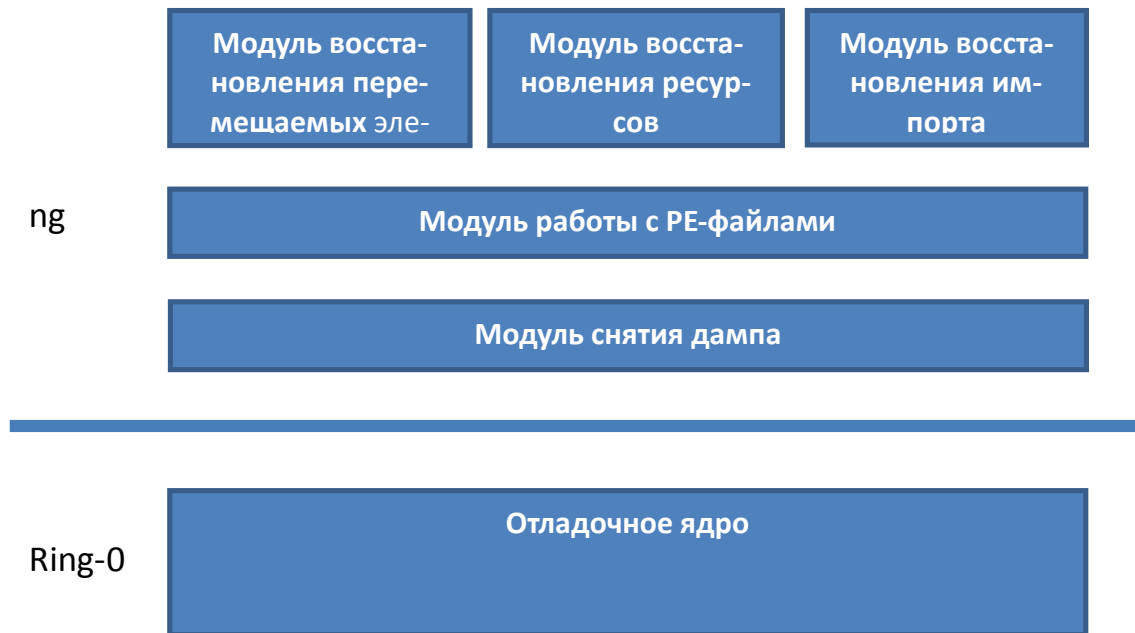
Рис. Предложенная архитектура ядра для построения распаковщиков
