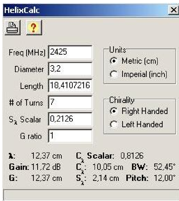
Рис. 2. Программа HelixCalc с результатом моделирования спиральной антенны
