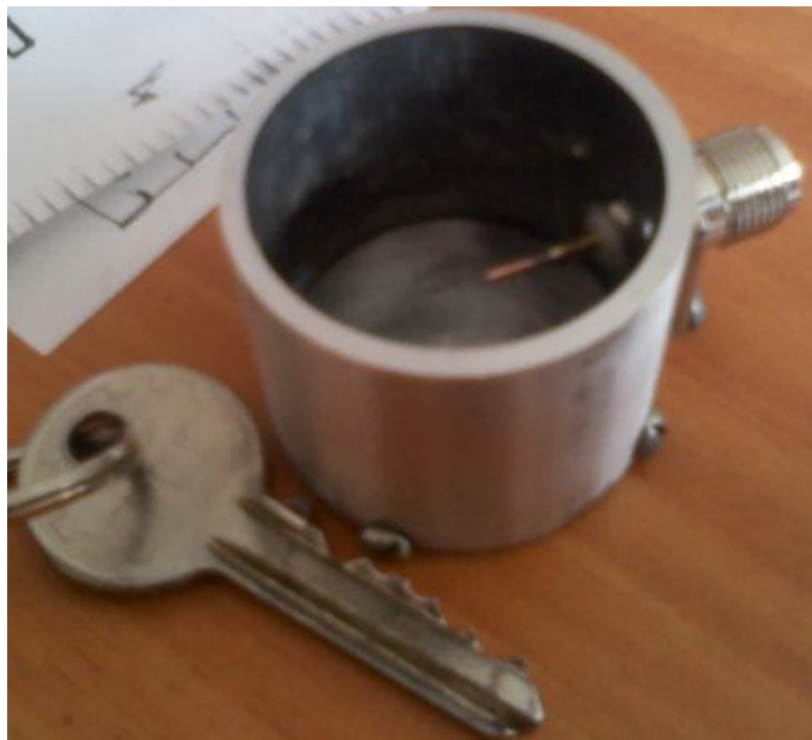
Рис. 5. Четвертьволновая антенна с цилиндрическим волноводом
