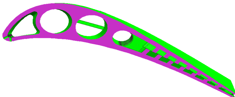
Рис. 2. Модель циклонно-вихревой системы охлаждения [3]
