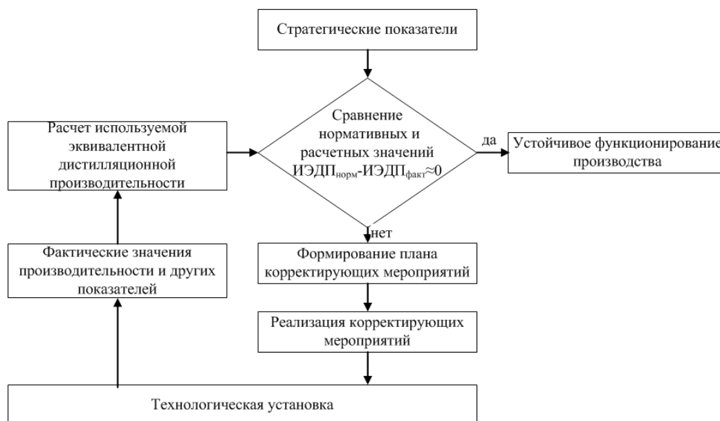
Рис. 9. Система управления технологическими установками по значениям ИЭДП
