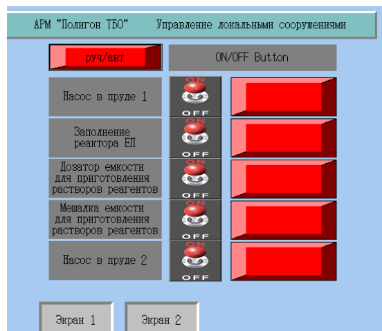
Рис. 3. Структура диалогового окна управления системой рециркуляции фильтрата
