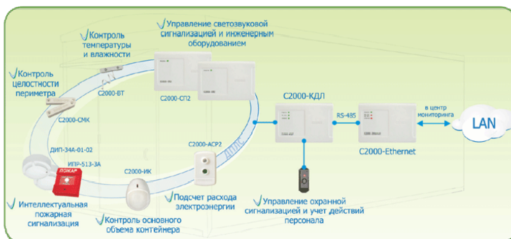
Рис. 1. Типовой набор устройств ИСБ «Орион»
