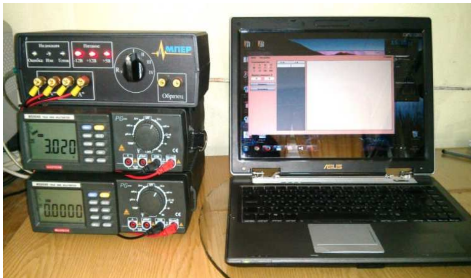
Рис. 5. Вид измерительного комплекса «Ампер» в целом для проведения исследований вольт-амперных характеристик
