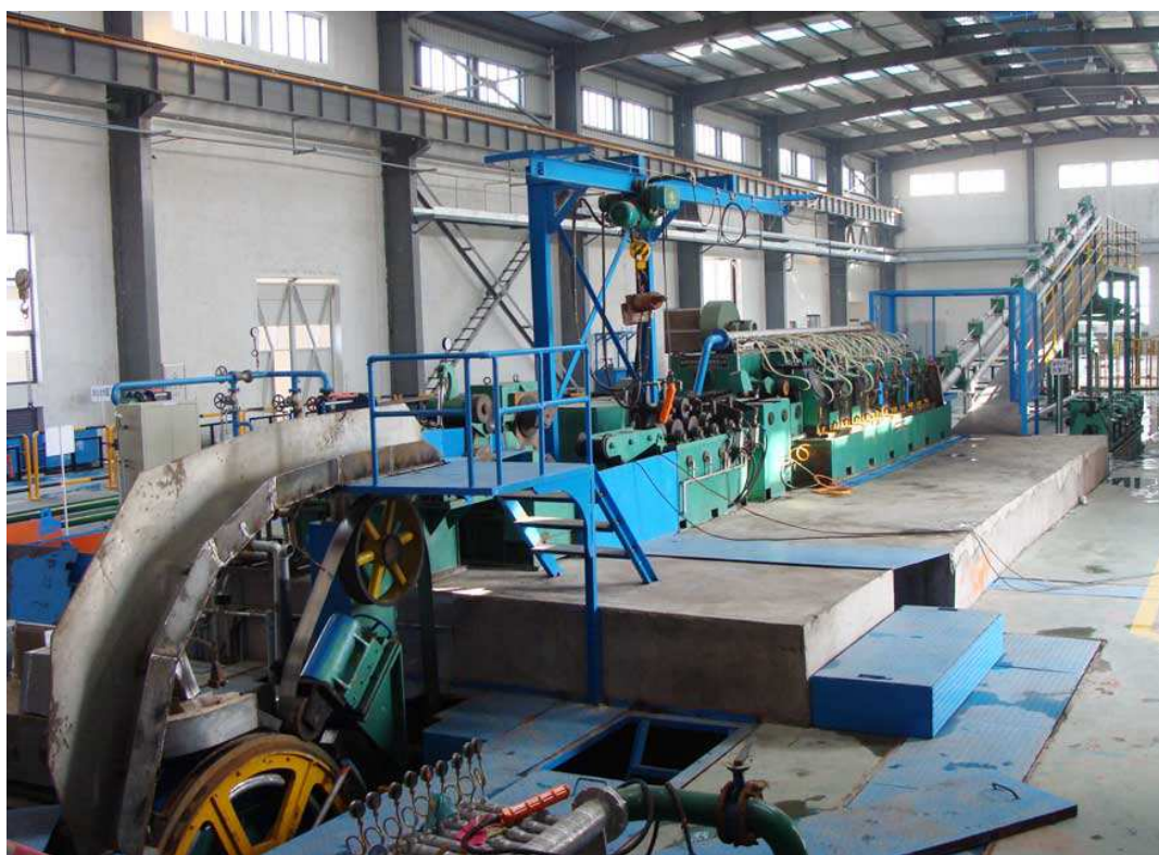
Рис. 1. Литейно-прокатный агрегат для производства алюминиевой катанки
