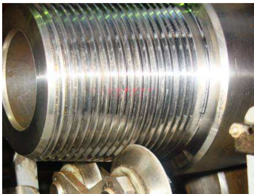
Рис. 5. Обкатка резьбы буровой трубы роликами
