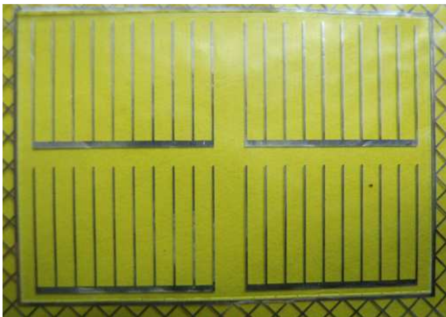
Рис. 3. Внешний вид исследовательского образца тонкопленочного емкостного преобразователя для акустического контроля металлических изделий
