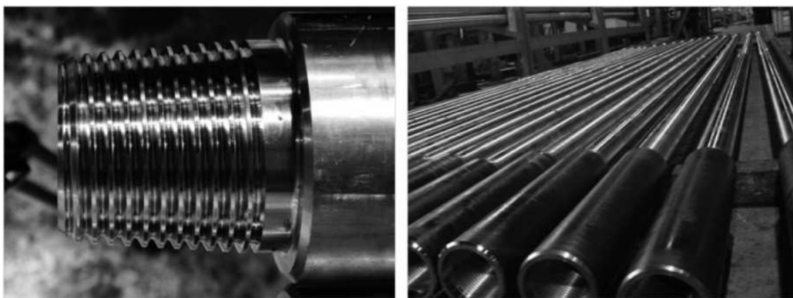
Рис. 1. Резьбовое соединение буровых труб: a – nipple-часть; б – муфтовая часть
