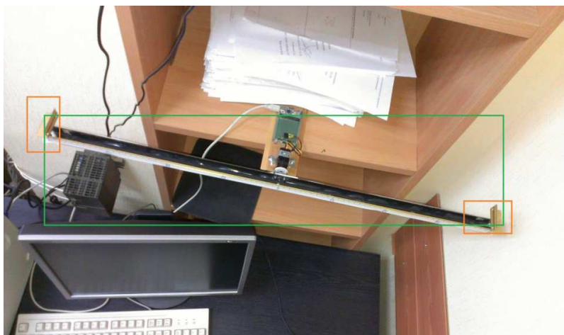
Рис. 2. Результат распознавания балансира усовершенствованным методом
