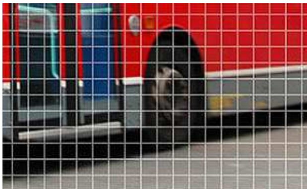
Рис. 4. Разбиение того же кадра на макроблоки в AVC
