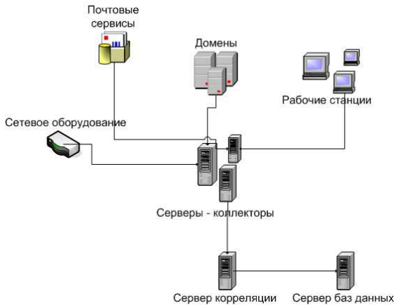
Рис. 1. Структура основных компонентов SIEM-систем
