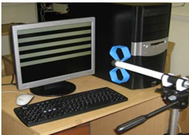
Рис. 2. Размещение антенны и источника ПЭМИ
