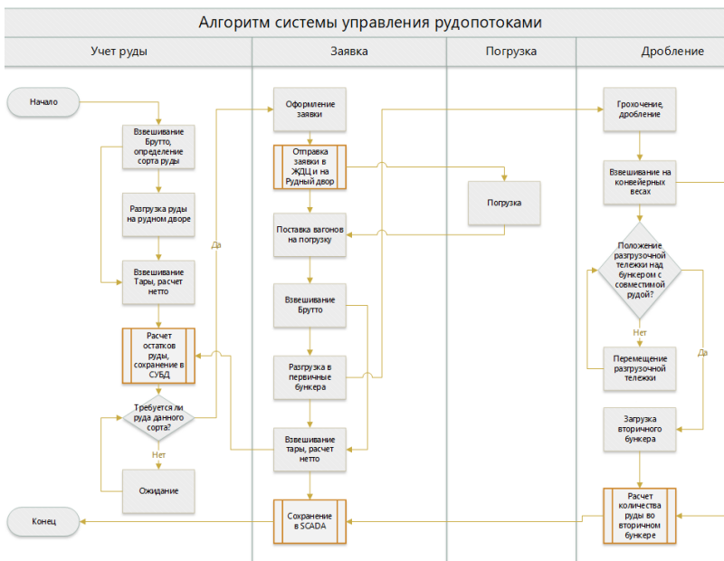
Рис. 3. Алгоритм системы управления сырьевыми потоками
