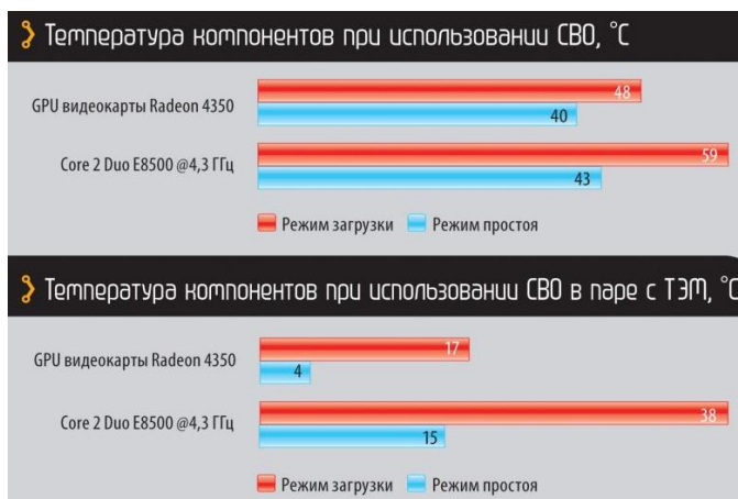
Рис. 1. Сравнительная характеристика системы охлаждения с использованием элемента Пельтье и без такового
