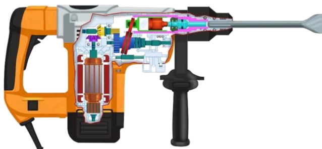
Рис. 5. Перфоратор с вертикальным расположением двигателя в разрезе
