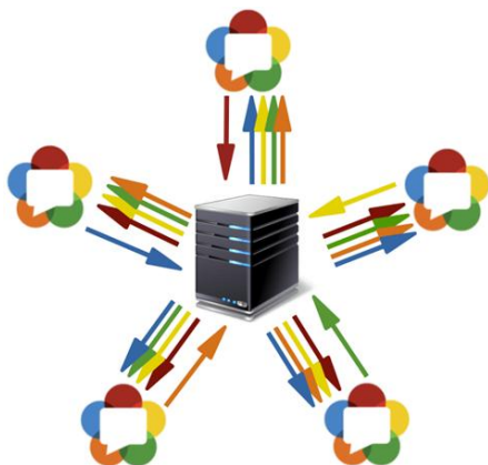
Рис. 2. Схема соединения с использованием сервера
