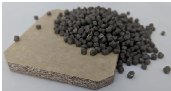
Рис. Переработка лопастей ветряных турбин в гранулы и древесноволокнистую плиту
