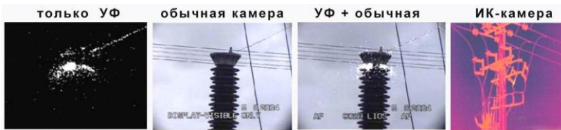
Рис. 3. Комплексные изображения в различных спектрах
