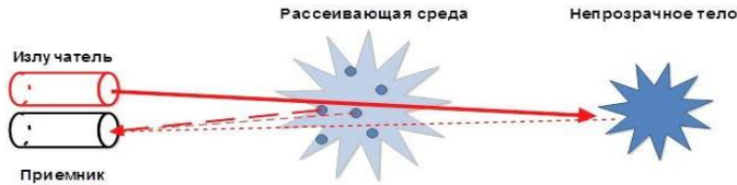
Рис. 1. Принцип работы лидара
