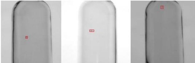
Рис. 1. Примеры определения дефектов для тела стеклотары
