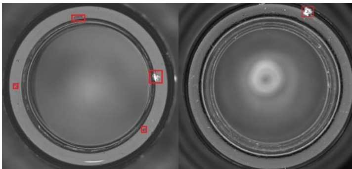
Рис. 2. Примеры определения дефектов для венчика стеклотары
