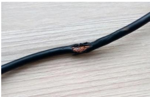
Рис. 2. Провод с видимыми повреждениями (URL: https://universe.roboflow.com/school-pxy7q/broken-normal-wire )
