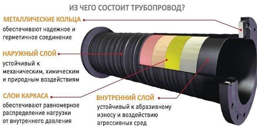
Рисунок 2 – Состав трубопровода и его конструктивные элементы
