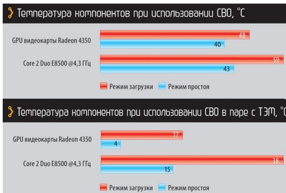
Рисунок 1 – Сравнительная характеристика системы охлаждения с использованием элемента Пельтье и без
